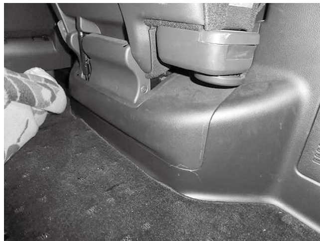
サービスパネル取り付け状態
