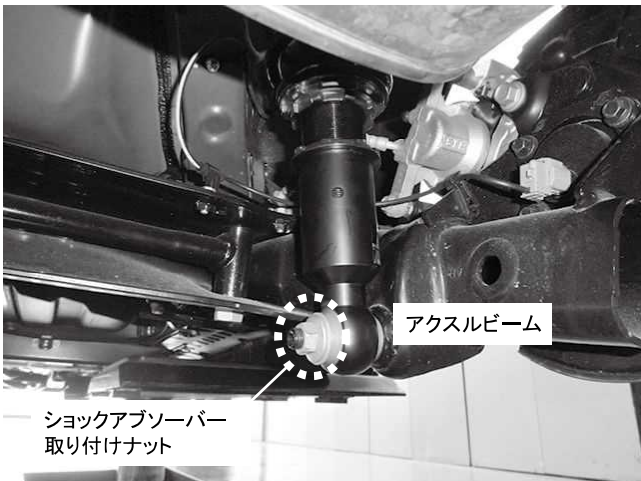
ショックアブソーバー取り付けナット 1カ所締め付け 締め付けトルク: 80\text{N}\cdot\text{m} ( 8.1\text{kgf}\cdot\text{m} )
