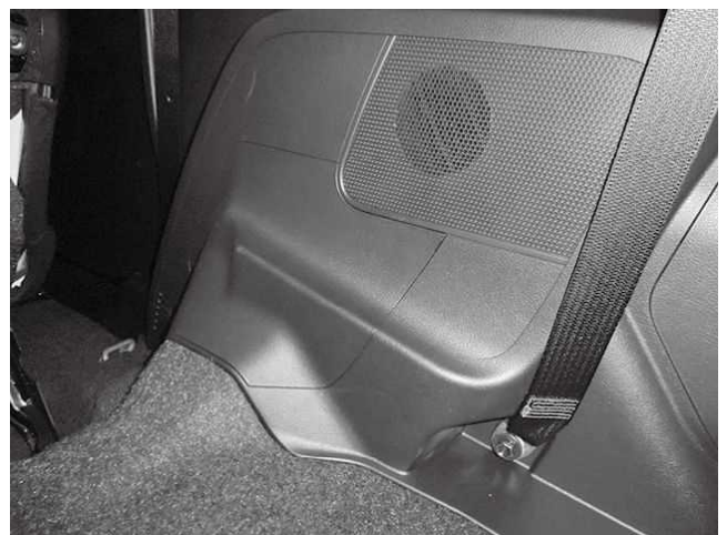
アップアマウント上部サービスパネルは 加工なく取り付け可能です 減衰力調整時には取り外して行ってください
