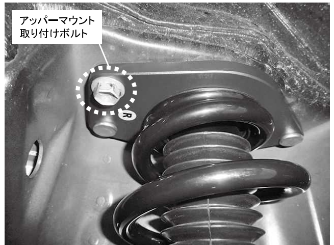
アップアマウント取り付けボルト 1カ所締め付け 締め付けトルク: 80\text{N}\cdot\text{m} ( 8.1\text{kgf}\cdot\text{m} )
