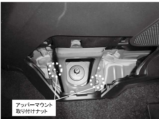
アップアマウント取り付けナット 2カ所締め付け 締め付けトルク: 80\text{N}\cdot\text{m} ( 8.1\text{kgf}\cdot\text{m} )
