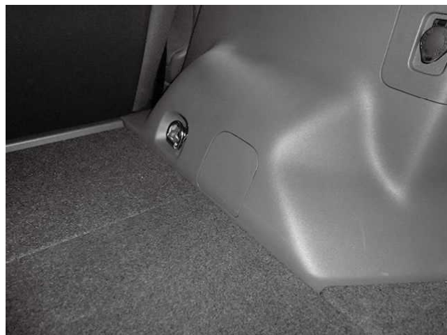
左右ともにリアショックに減衰ダイヤルを装着した状態でも、 ショック上部のサービスパネルは装着可能です
