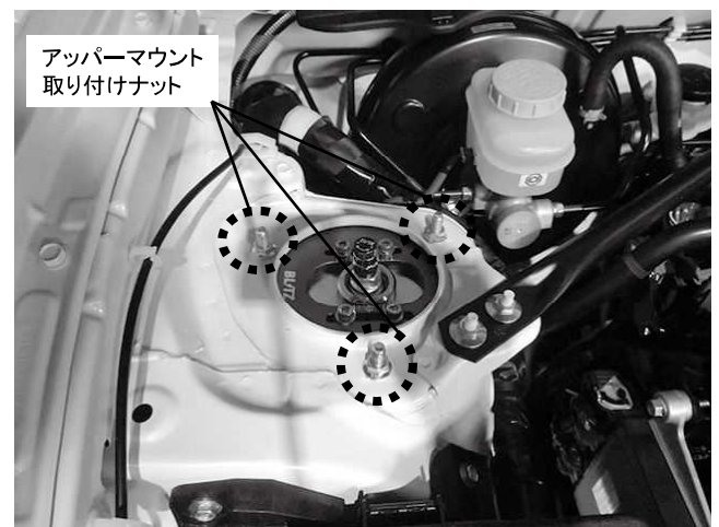
アッパーマウント 取り付けナット 3カ所締め付け 締め付けトルク: 23N・m(2.4kgf・m) ※製品付属のM8ナットを使用してください
