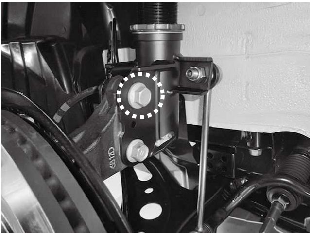
ナックルブラケット取り付けボルト上側は 純正でキャンバー調整機能付ボルトのため、 左右で位置を合わせて取り付けください
