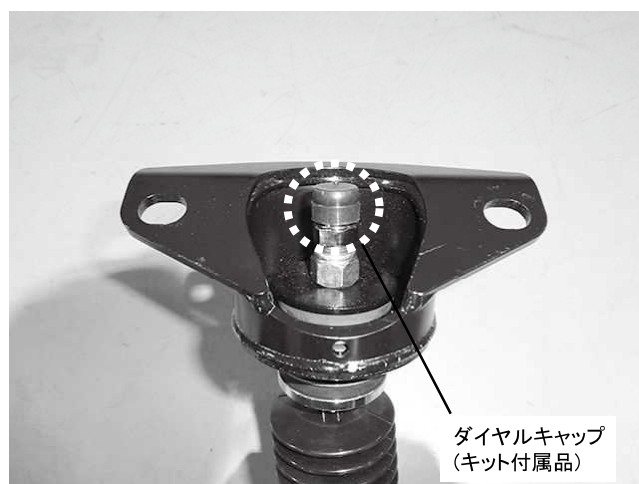
リアショック減衰ダイヤルに キット付属ダイヤルキャップを取り付けてください
