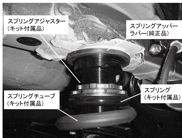
リアスプリング取り付け状態(上側) ※スプリングをサスペンションアームに取り付けの際、 純正スプリングラバーを取り付けてください ※スプリングが線間密着する際、必要に応じてスプリング チューブを使用してください
