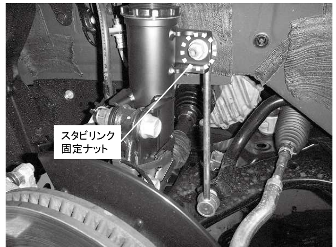
スタビリンク 固定ナット 1カ所締め付け 締め付けトルク: 74N・m(7.5kgf・m) ※純正スタビリンクを使用してください
