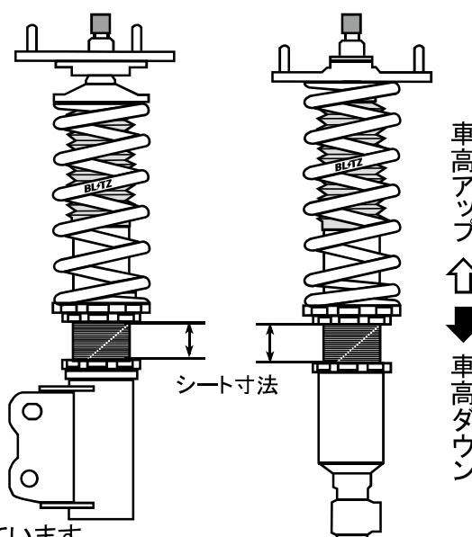
**走行前に法律で定められている最低地上高90mm以上(ホイールベースが3000mm以上の車両は最低地上高100mm以上)を確保しているか確認してください。2006年1月1日以降に生産された車両においては、前部霧灯(フォグランプ)の下縁高さが地上より250mm以上を確保しているか確認してください。スプリングの遊びがないか確認してください。**
