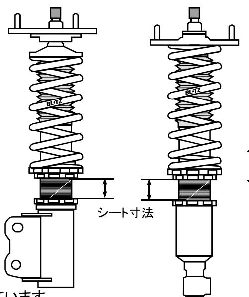
**走行前に法律で定められている最低地上高90mm以上(ホイールベースが3000mm以上の車両は最低地上高100mm以上)を確保しているか確認してください。2006年1月1日以降に生産された車両においては、前部霧灯(フォグランプ)の下縁高さが地上より250mm以上を確保しているか確認してください。スプリングの遊びがないか確認してください。**
