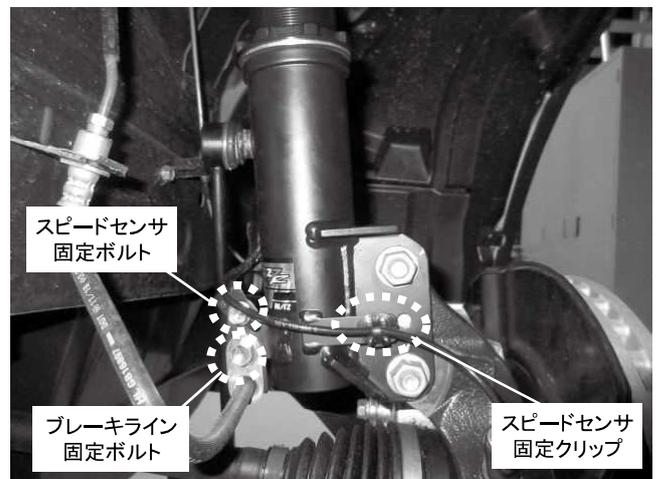
スピードセンサ固定ボルト 1カ所締め付け
