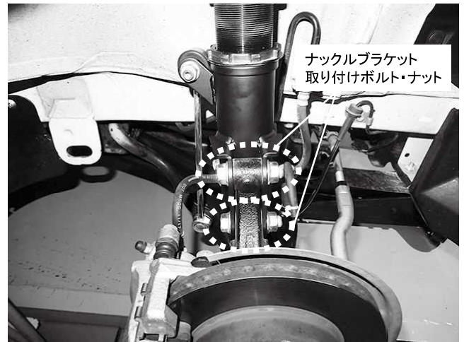
ナックルブラケット 取り付けボルト・ナット 2カ所締め付け 締め付けトルク: 95\text{N}\cdot\text{m} ( 9.7\text{kgf}\cdot\text{m} )
