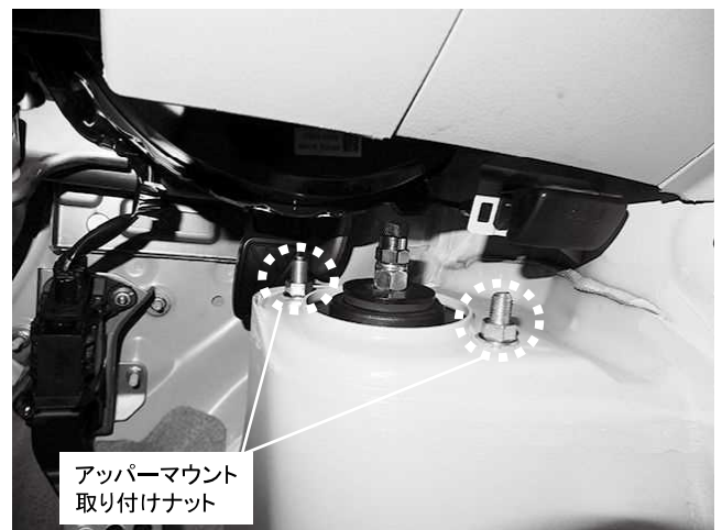
アッパーマウント 取り付けナット 2カ所締め付け 締め付けトルク: 73\text{N}\cdot\text{m} ( 7.4\text{kgf}\cdot\text{m} ) ※製品付属のM10ナットを使用してください
