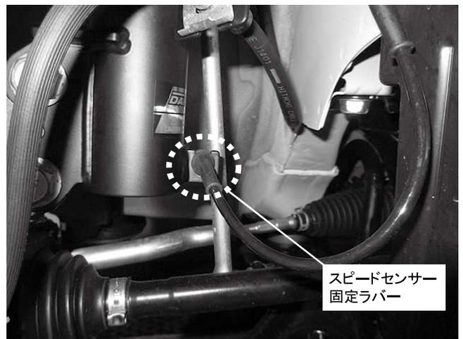
スピードセンサー固定ラバー 1カ所取り付け
