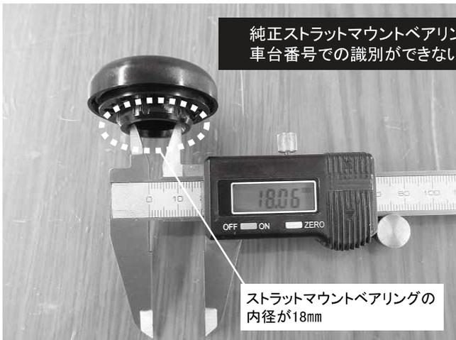
車両によって純正品ストラットマウントベアリングの内径寸法が20mmと18mmの2種類存在します
