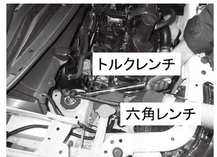
下記規定トルクを参照し、**トルクレンチ**を使用して必ず締め付け確認を行ってください。
