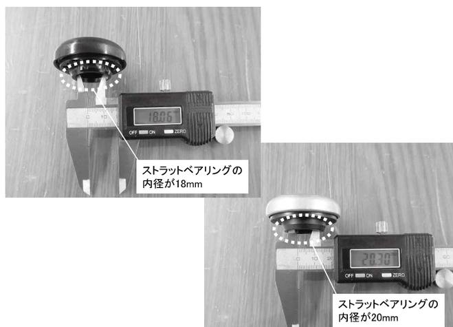
年式等によって純正品ストラットベアリングの内径寸法が、
