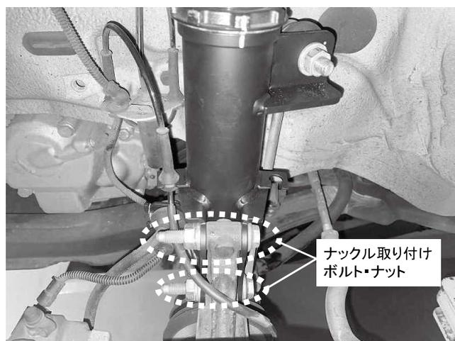
ナックル取り付けボルト・ナット 2カ所締め付け
