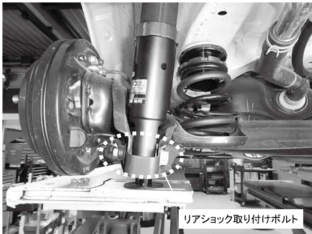
リアショック取り付けボルト 1カ所締め付け 締め付けトルク: 75\text{N}\cdot\text{m} ( 7.6\text{kgf}\cdot\text{m} )
