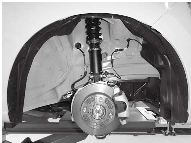
フロント右側(運転席側)取り付け状態 ※車両によってはスタビリンク取付用の ステーは使用しません
