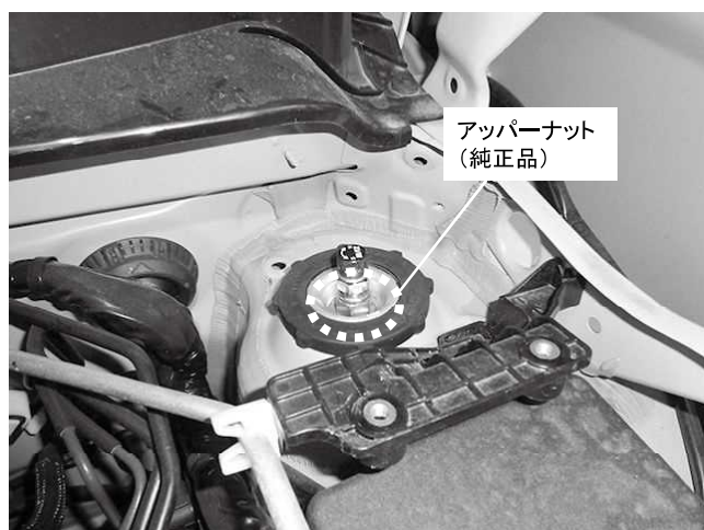
上写真を参照し、車両に取り付けてください アッパーナット 1カ所締め付け 締め付けトルク: 40\text{N}\cdot\text{m} ( 4.1\text{kgf}\cdot\text{m} )
