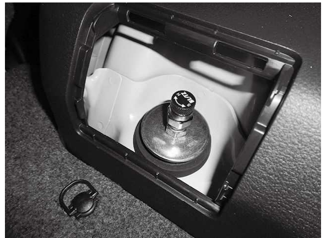
リアショック取り付け状態 ※サービスパネルは加工せずにそのまま装着可能です ※減衰調整の際はサービスパネルを取り外してください
