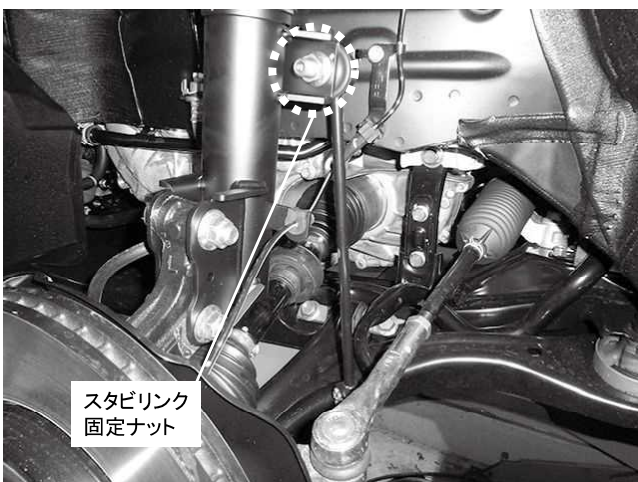
スタビリンク固定ナット 1カ所締め付け 締め付けトルク: 88\text{N}\cdot\text{m} ( 8.9\text{kgf}\cdot\text{m} ) ※純正スタビリンクを使用してください
