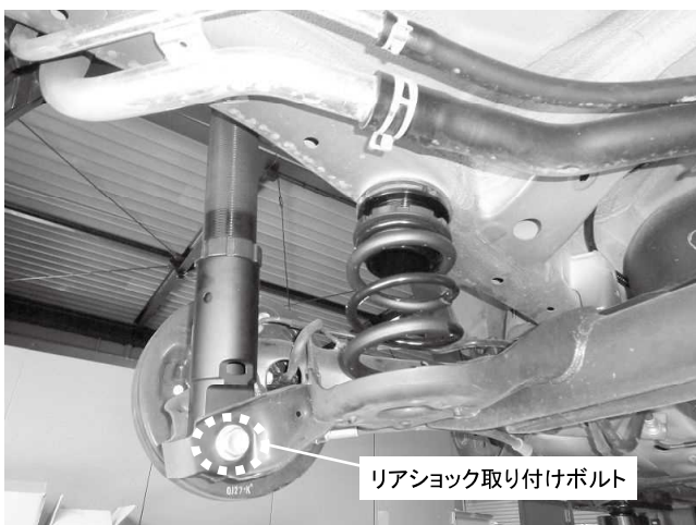
リアショック取り付けボルト 1カ所締め付け 締め付けトルク: 75N・m(7.6kgf・m)
