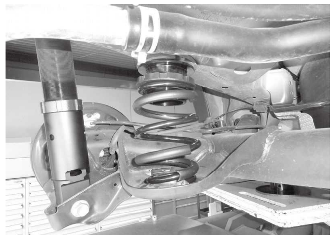
リアスプリング取り付け状態 ※スプリングアッパーラバーがしっかりとハマっているか確認してください ※スプリングロアシートがしっかりとハマっているか確認してください ※スプリングの切り欠きの位置があっているか確認してください
