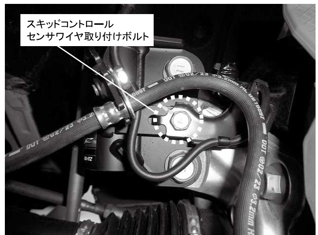
スキッドコントロールセンサワイヤ取り付けボルト 1カ所締め付け 締め付けトルク: 18.8N・m(1.9kgf・m) ※ネジ部に塗装がついて締め付けが渋い場合があります
