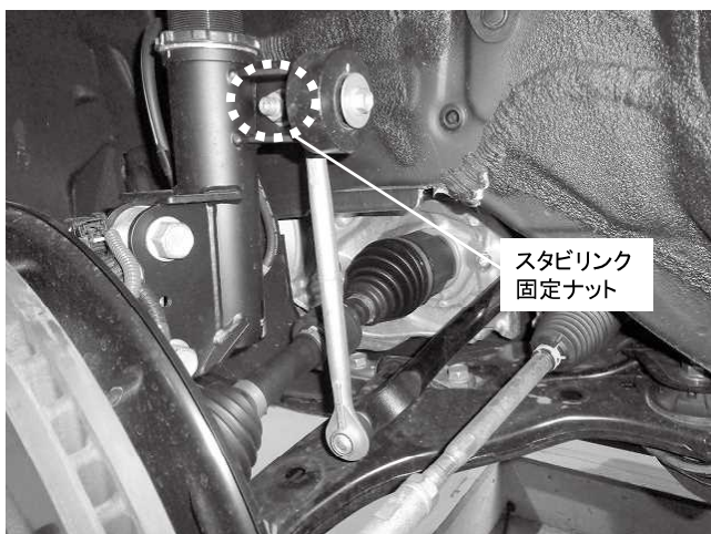
スタビリンク固定ナット 1カ所締め付け 締め付けトルク: 74N・m(7.5kgf・m) ※スタビリンクは純正品を使用してください
