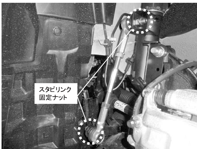
スタビリンク固定ナット 2カ所締め付け 締め付けトルク: 84\text{N}\cdot\text{m} ( 8.6\text{kgf}\cdot\text{m} ) ※長さを調整しキット付属のスタビリンクを使用してください
