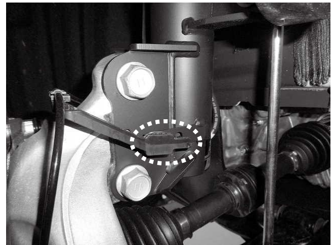
AVS非装着車の場合は上写真のステーを使用し スピードセンサーハーネスクリップを取り付けてください ※クリップがブラケットに固定できない、またはハーネスが突っ張ってしまう場合にはクリップをハーネスから取り外し、クリップをロアブラケットに付けてからハーネスを取り付けてください
