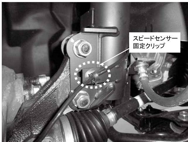
スピードセンサー固定クリップ 1カ所取り付け
