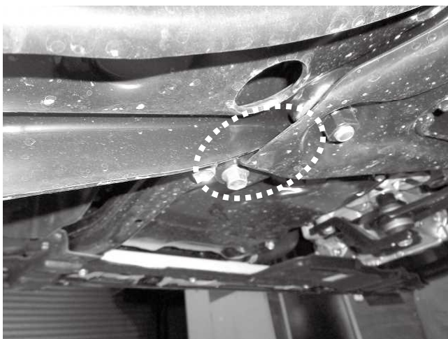
フロント左(助手席)側の取り付け後の写真になります ロアアームとフロントメンバーが干渉していないか 確認してください ※写真は基準車高(寸法)の0G時状態です
