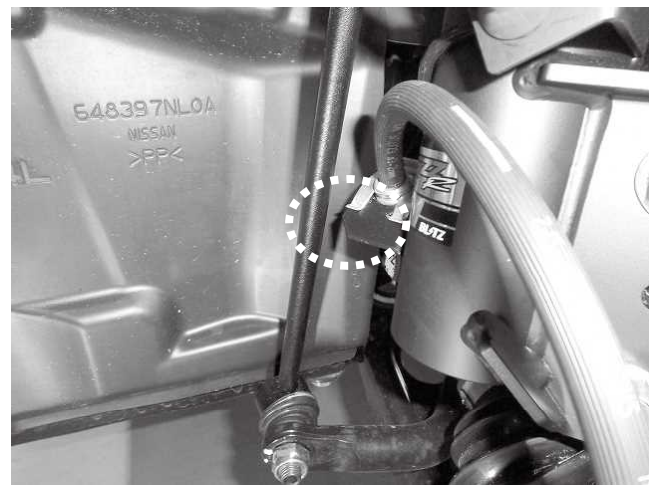
フロント左(助手席)側の取り付け後 ステアリングを左へ末切りした写真になります ブラケットとスタビリンクが干渉していないか 確認してください ※写真は基準車高(寸法)の0G時状態です
