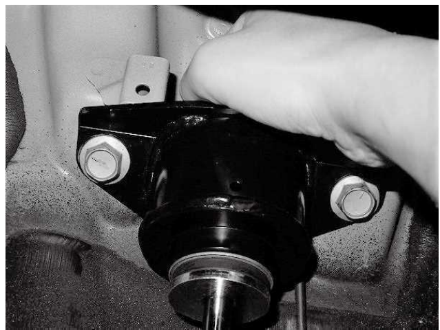
必要に応じて、タイヤハウス内のクリップを外し、 インナーフェンダーをめくると、リアショック上部に アクセスでき、減衰調整ダイヤルを回すことが可能です ダイヤルキャップを取り付けた状態で回すことができます ※確認車両データを確認して初めてご使用される際の推奨減衰力に合わせてください
