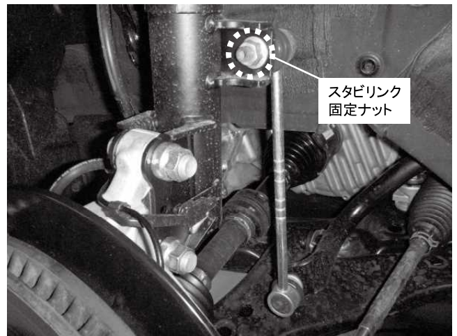
スタビリンク固定ナット 1カ所締め付け 締め付けトルク: 74N・m(7.5kgf・m) ※スタビリンクは純正を使用してください
