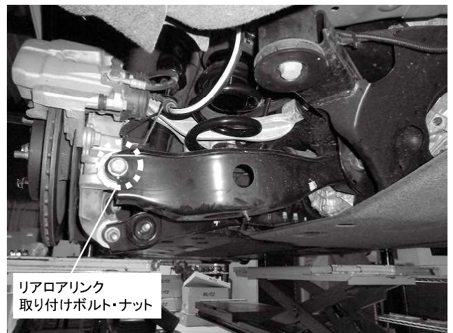
リアロアリンク取り付けボルト・ナット 1カ所締め付け 締め付けトルク:188N・m(19.0kgf・m)
