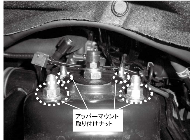
アッパーマウント取り付けナット 4カ所締め付け
