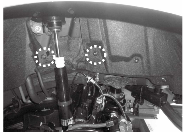
必要に応じて、タイヤハウス内のクリップを外し、 インナーフェンダーをめくると、リアショック上部に アクセスでき、減衰調整ダイヤルを回すことが可能です ※ダイヤルキャップを取り付けた状態で回すことができます
