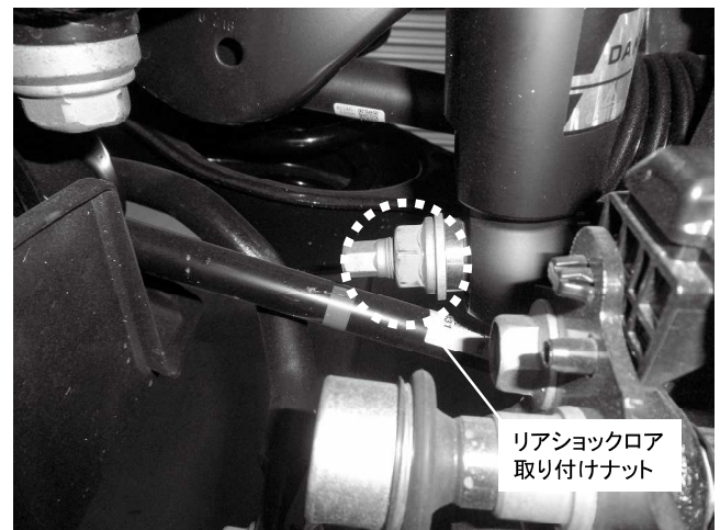
リアショックロア取付けナット 1カ所締め付け 締め付けトルク: 135\text{N}\cdot\text{m} ( 13.8\text{kgf}\cdot\text{m} )
