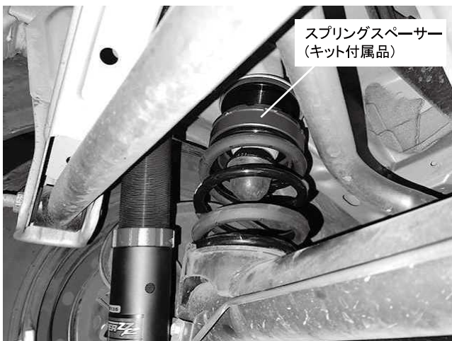
リアスプリングスペーサー取り付け状態
