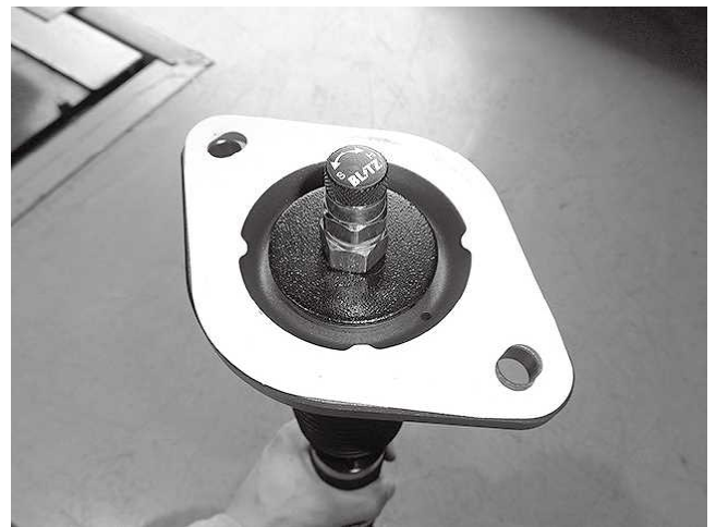
リアアッパーマウント取り付け時、 純正アッパーマウントについているマウントシールを剥がし、 再使用し車両へ取り付けください ※確認車両データを確認して初めてご使用される際の推奨減衰力に合わせてください
