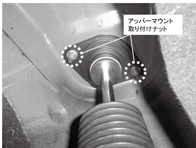
アッパーマウント取り付けナット 2カ所締め付け 締め付けトルク: 28\text{N}\cdot\text{m} ( 2.9\text{kgf}\cdot\text{m} ) ※純正ナットを使用してください
