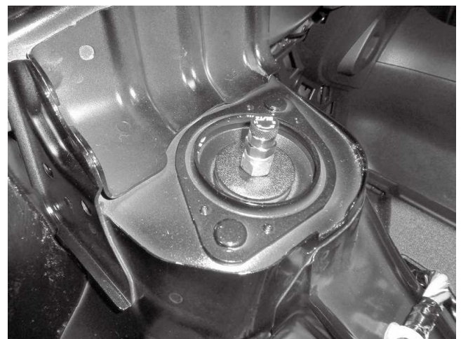
アッパーマウント取り付け状態 ※内装パネルは加工せずに取り付け可能ですが 減衰力調整時に内装パネルの脱着が伴います 必要に応じて内装パネルへ穴あけ加工をしてください
