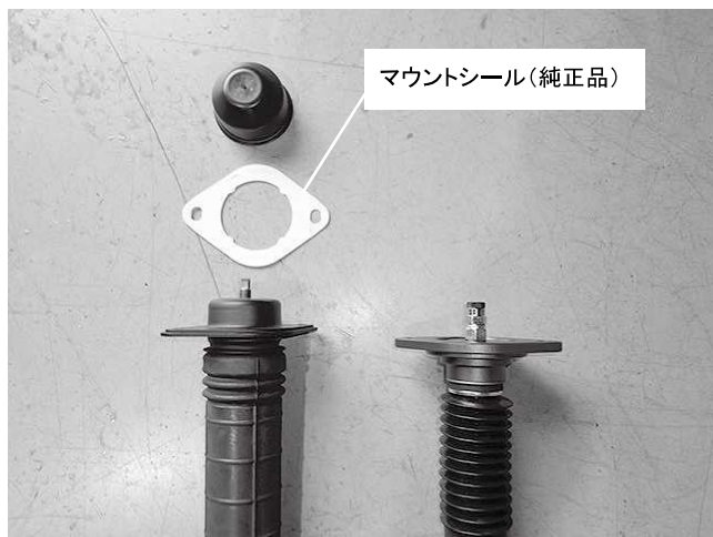
純正ショックからマウントシールを外します
