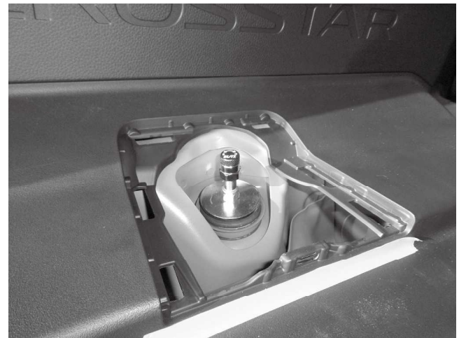
トップナット締め付け状態 (GT2)
