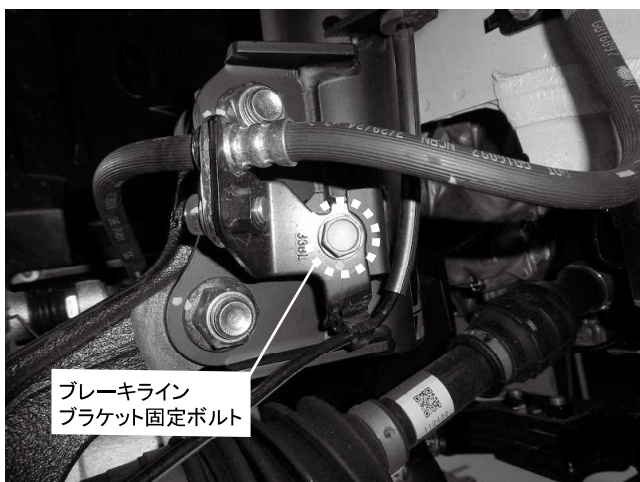
ブレーキラインブラケット固定ボルト 1カ所締め付け 締め付けトルク: 22\text{N}\cdot\text{m} ( 2.2\text{kgf}\cdot\text{m} ) ※ネジ部に塗装がついて締め付けが渋い場合があります
