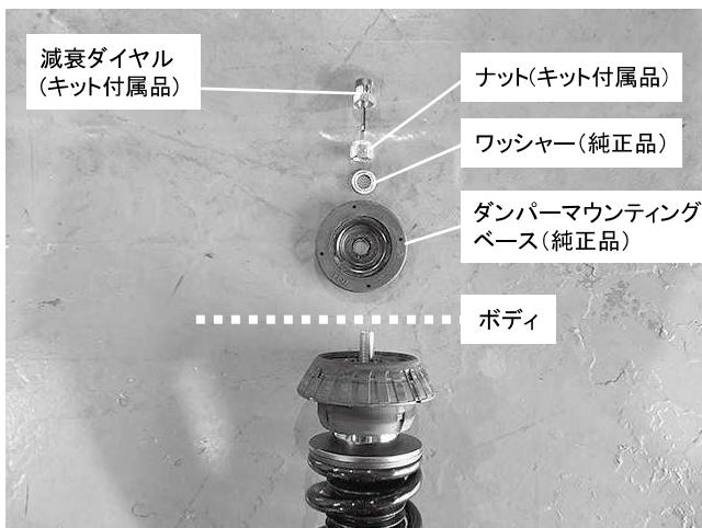
上写真を参照し、車両に取り付けてください トップナット締め付け 締め付けトルク: 49\text{N}\cdot\text{m} ( 5.0\text{kgf}\cdot\text{m} )
