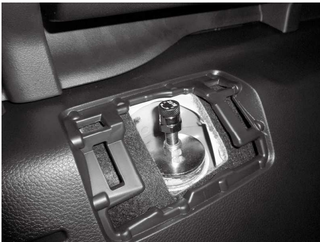
トップナット締め付け状態 (GT5)
