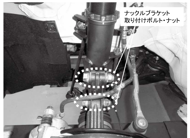
ナックルブラケット取り付けボルト・ナット 2カ所締め付け 締め付けトルク: 90\text{N}\cdot\text{m} ( 9.2\text{kgf}\cdot\text{m} ) ※取り付け上部は長穴になっておりキャンバー調整が可能です
