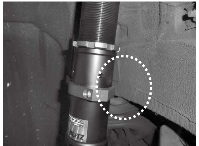
リザーバータンク固定ステーと インナーフェンダーとの干渉に 注意してください。
