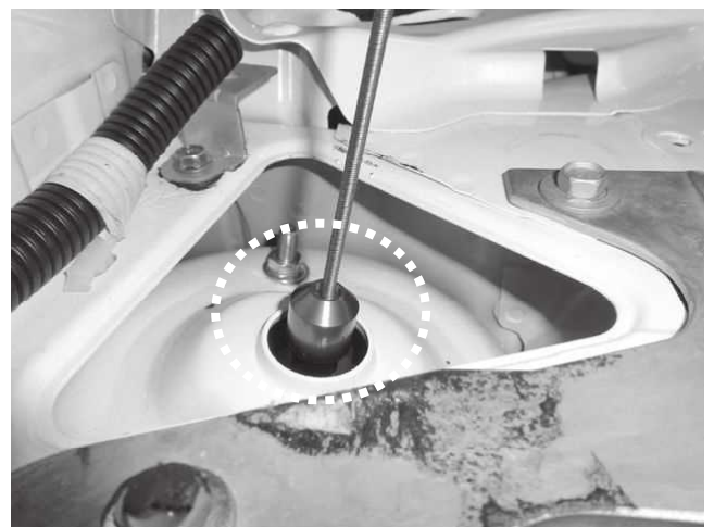
ショックアブソーバーを車両に取り付ける前に 減衰力延長ダイヤルをつけてください。 フレームが邪魔してダイヤルを固定できない場合があります。
