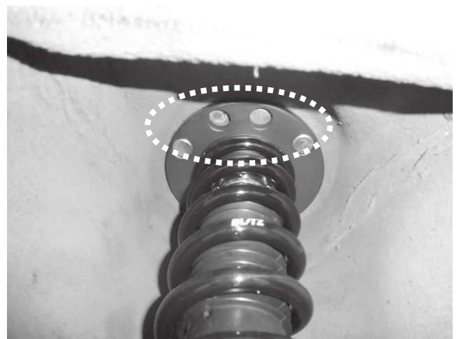
ボディ側アップアマウント取り付け位置に 突起のある車両は、アップアマウントの穴を 合わせて取り付けしてください。
