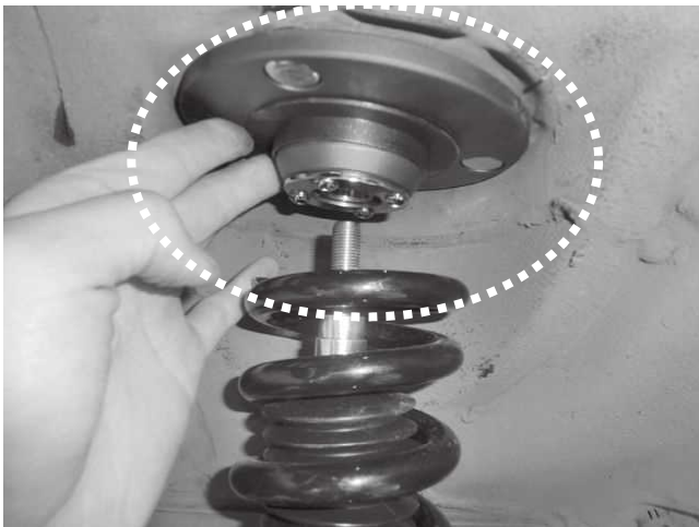
Aアームを通した後にアップアマウントを取り付けて ください。アップアマウントを組み付けた状態だと 別体タンクが付いているため取り付けできません。
