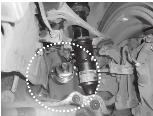
リザーバートank(固定ステー)とロアアーム、 インナーフェンダーとの干渉に注意してください。
