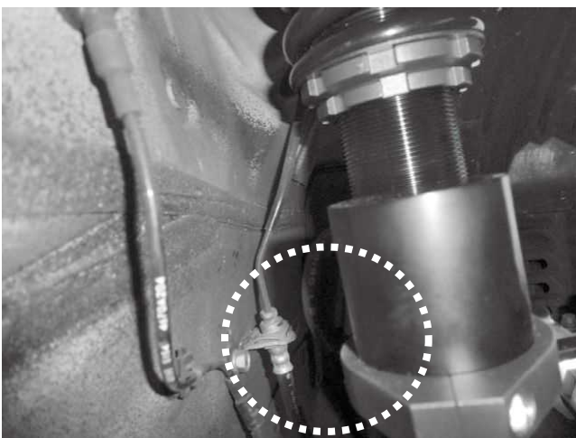
リザーバータンク(固定ステア)と インナーフェンダー、ブレーキラインとの 干渉に注意してください。
