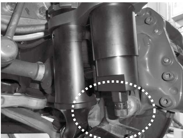
リザーバータンクとロアアーム、ナックル 取り付け部分との干渉に注意してください。
