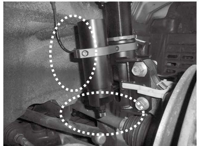
リザーバータンク(固定ステア)と ドライブシャフト、ロアアーム、インナー フェンダーとの干渉に注意してください。
