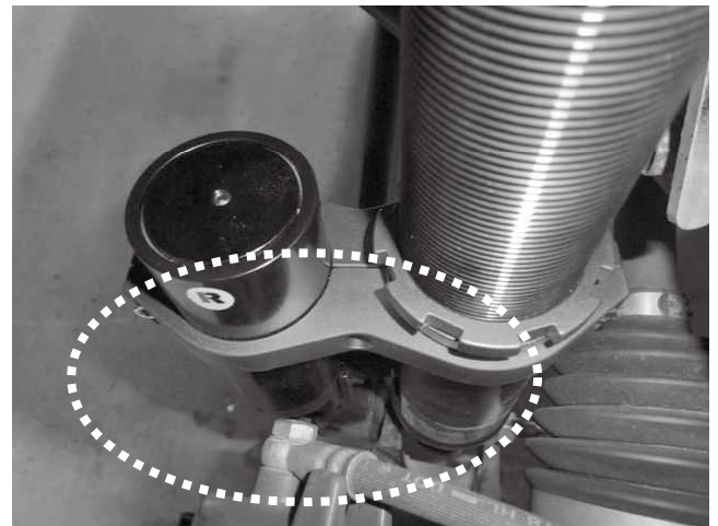
リザーバータンク固定ステーと ブレーキキャリパー・ブレーキラインとの干渉に 注意してください。
