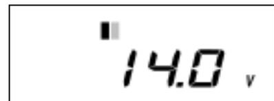
既に通電されている時（以降）の設定は、前回イグニッション O F F した時の状態を記憶しており、その状態になります。記憶される内容は の設定項目と同様です。イグニッションを O N すると、約 3 秒間は電圧を表示しながら 2 セグメントのバーグラフが流れます。（その間 A U T O 演算は行っておりません）その後、設定された表示モードに切り替わります。A U T O ・ E モード時のバーグラフの流れ方は、A U T O タイマー値表示中、S E C スイッチ操作によって変更できます。
