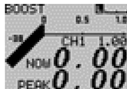
あとは走行するだけでSBC i - Dが自動的に目標ブーストへ補正します。
