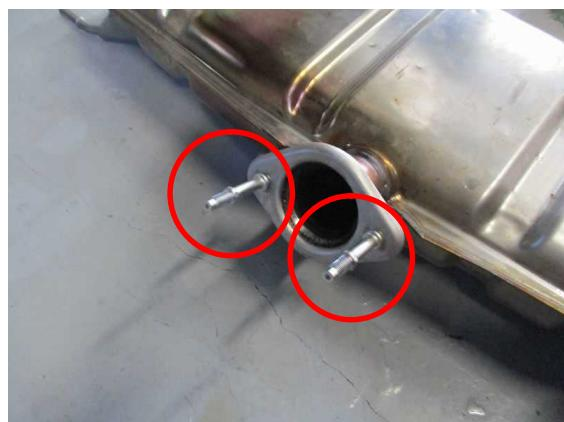
2) 製品マフラーに取り付けを行い、マフラーを組み立ててください。取り付けにはダブルナットなどを利用してください。
