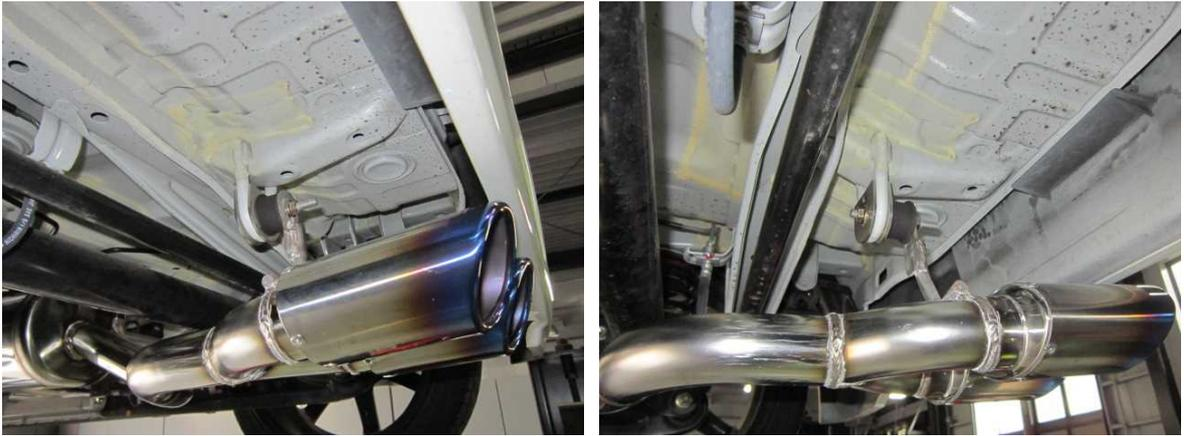
専用ステー2枚で牽引フックを挟むように防振ゴムのM8ボルトとナットで図のように固定します。
