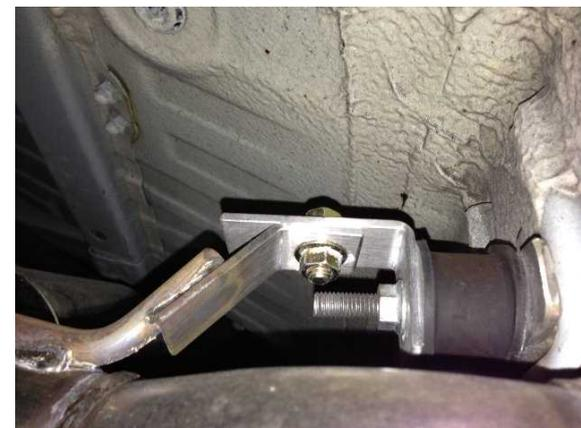
牽引フック固定用ステー2個で牽引フックを挟むように防振ゴムを取り付け、
