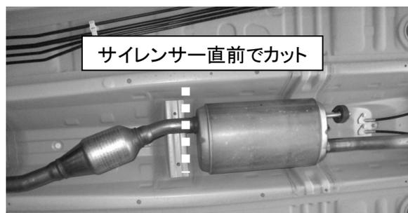
2) 写真を参考に製品を純正マフラーに差込み、バンドで固定してください。
