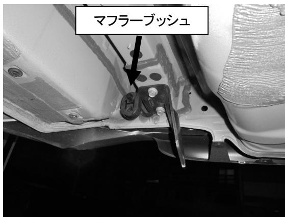
3)運転席側リアメンバー後ろのM8ボルト2本を取り外し、M8ボルトを使用して専用ステーを装着してください。その後専用ステーにマフラーーブッシュを装着してください。
