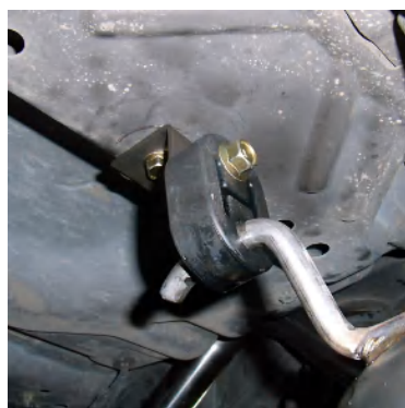
①吊りゴムのブラケット部
