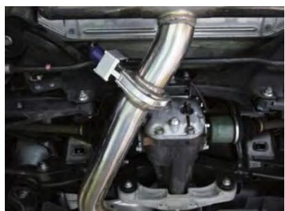
※本製品はマフラーの法兰ジ間に挟み込んで装着するため、本製品の装着位置より後方のマフラーの位置関係にズレが生じます。
