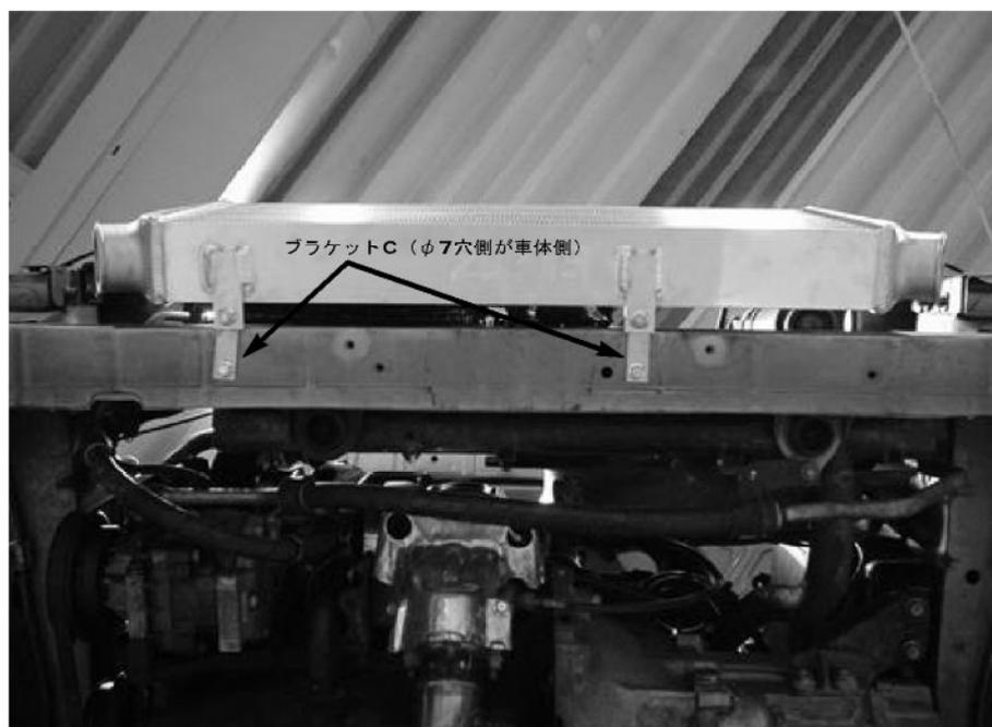
※インタークーラーが水平になるように調節しボディの各部に干渉しないか確認して固定して下さい。
