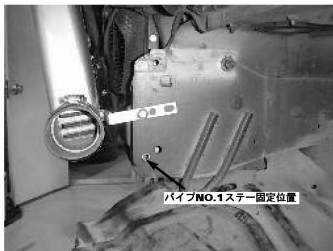
※インタークーラーが水平になるように調整し、ボディの各部に干渉しないか確認して固定して下さい。
