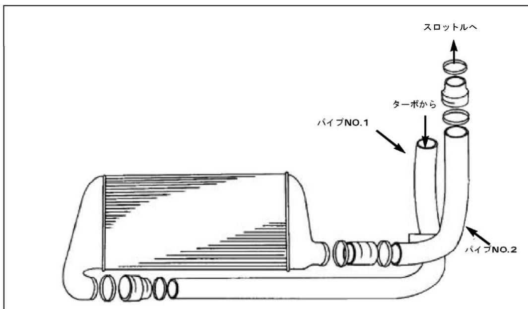
※付属のボルト・ナット(M8)を使用してパイプNo.1をボディに固定して下さい。
