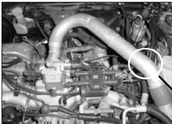
※スロットル下のヒーターホースのクランプがパイプNo.1に干渉する場合はクランプの向きを変えて下さい。
