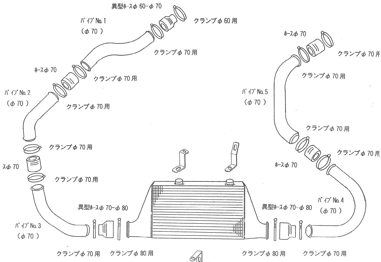
注1) 各インテークパイプが、ボディー・A/Cチューブ・パワステクーラーホース等に干渉しないように調節してください。特にNo.5のパイプは、ファンベルトや電動ファンとのクリアランスに注意してください。
