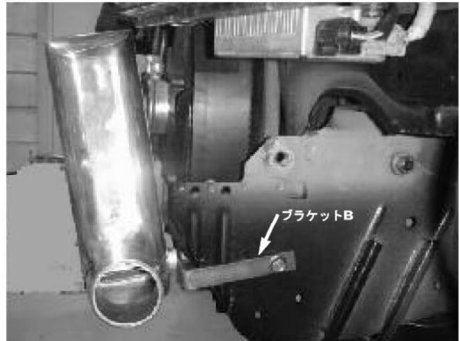
図はER34です。ECR33はブラケットCを使用してフードロックに共締めして下さい。
