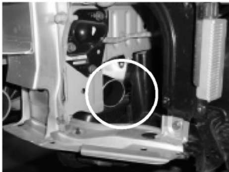
純正ソレノイドへの配管等がパイプNo.7に干渉しないように注意 ブレーキマスターシリンダーの配管への干渉に注意 パイプNo.1との干渉に注意
