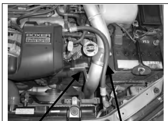
エアコンホース
