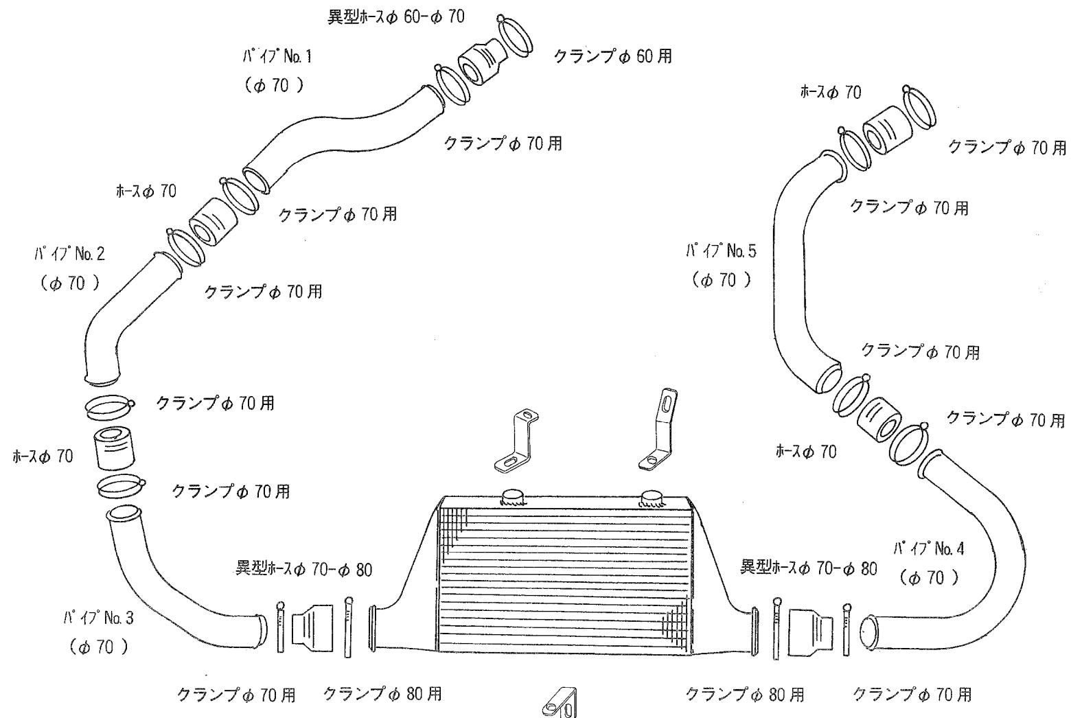
注1) 各インタークパイプが、ボディー・A/Cチューブ・パワステクーラーホース等に干渉しないように調節してください。特にNo.5のパイプは、ファンベルトや電動ファンとのクリアランスに注意してください。
