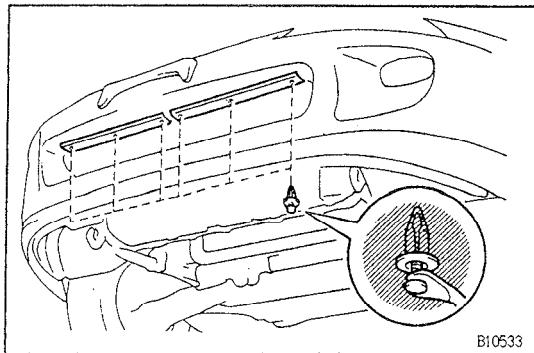
(3) クリップリムーバーを使用してクリップ6個をはずし、フロントバンパーロワーリテナーを取りはずす。
