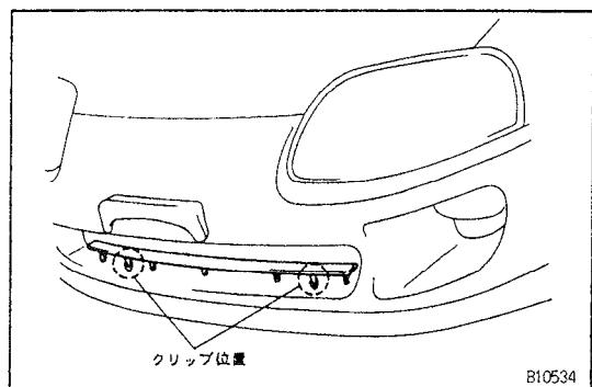
(4) クリップリムーバーを使用してクリップのかん合をはずし、フロントバンパーロワーセンターNo.2リテナーを取りはずす。
