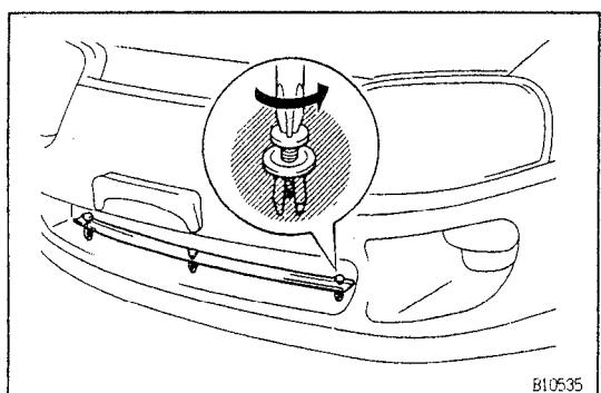
(5)  $\oplus$ ドライバーを使用してクリップ3個をはずし、フロントバンパーロワーセンターNo.2リテナーを取りはずす。
