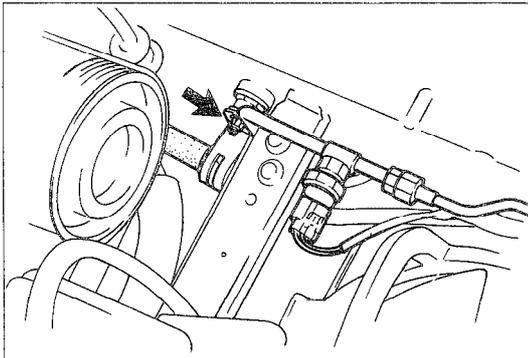
3. 図示箇所のA/C高圧パイプ・ブラケットを取外す。
