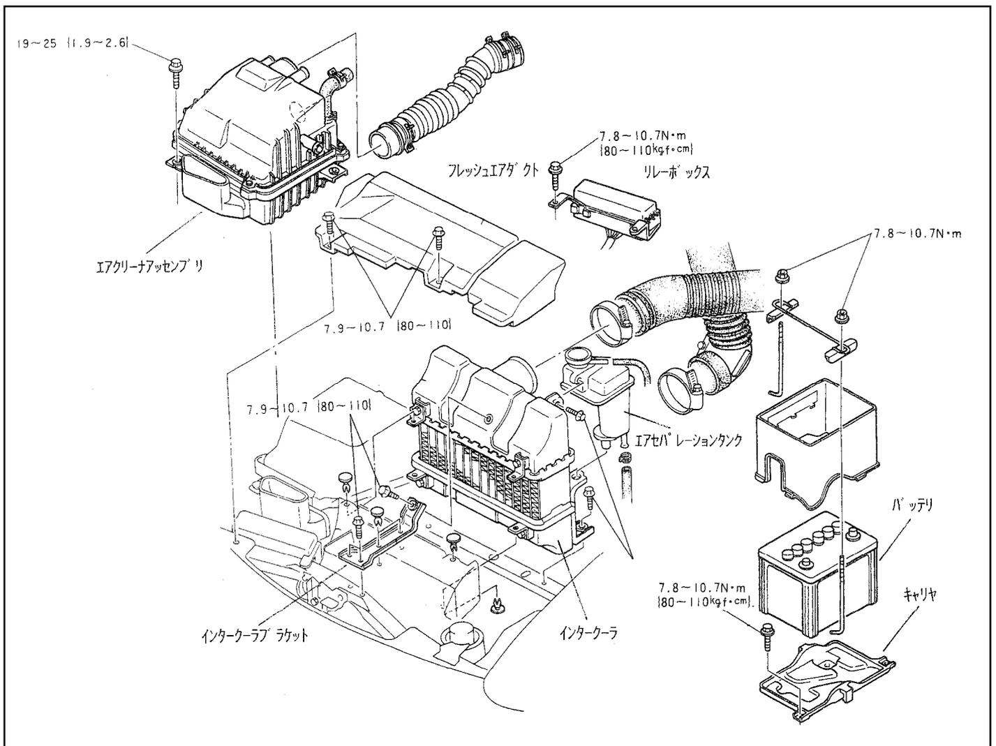
2. バッテリーのマイナス端子を外し、バッテリー及びキャリヤを取り外して下さい。
