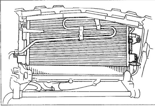
1. 図示のボルトを外し、コンデンサ・アッセンブリをラジエータより少し離して車体側にロープ等で吊っておく。
