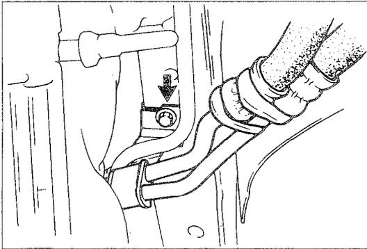
2. 図示箇所のオイル・パイプ・ブラケットを取外す。
