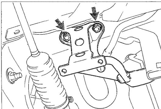
4. ラジエータ アンド 電動ファンが落下しないよう保持しながらラジエータ・ブラケットを取外す。
