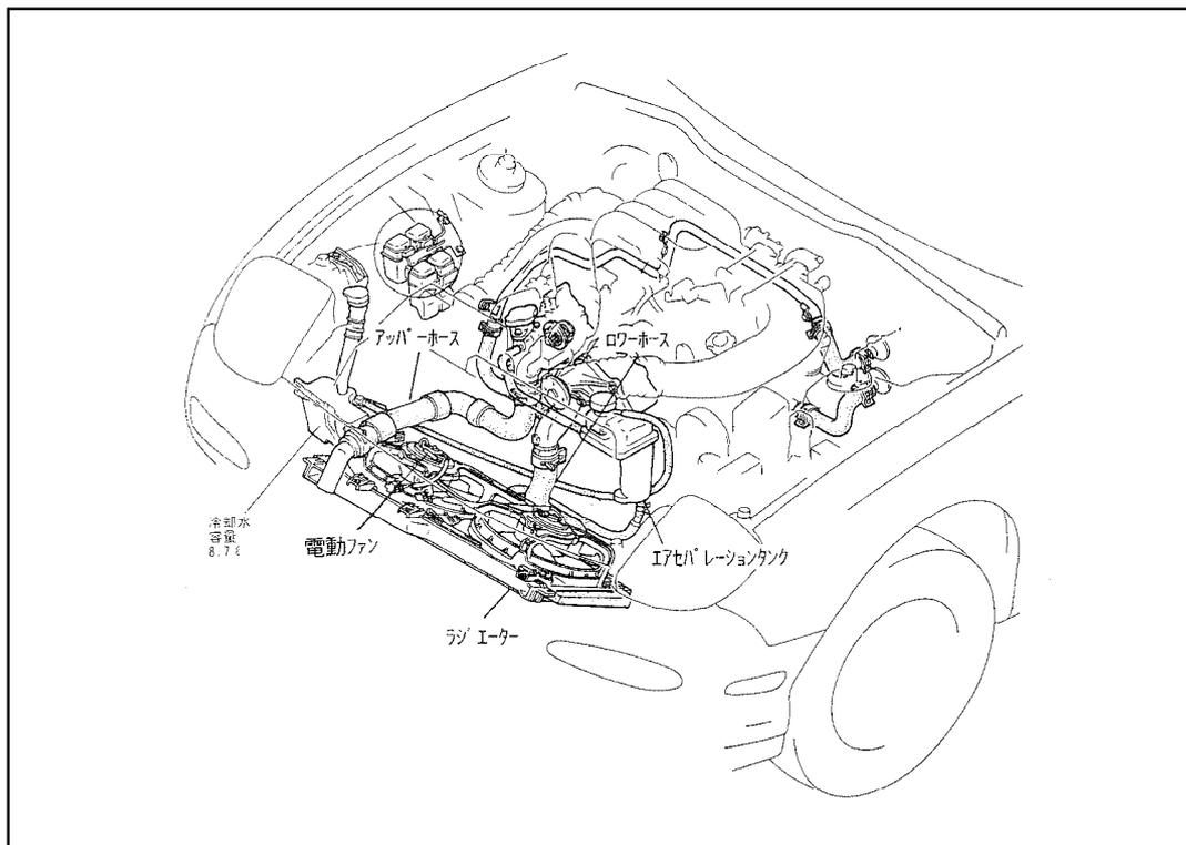
11. 下図に従いラジエーター及び電動ファンを車輻より取り外して下さい。
