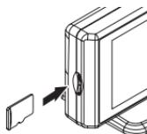
microSDHCカードの端子部が本体背面を向くように挿入し、「カチッ」と音が鳴るまで軽く押しこんでください。
