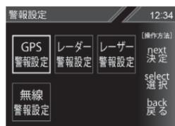
3. 【セレクトスイッチ】で【GPS 警報設定】を選択し、【ネクストスイッチ】で決定します。
