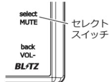
2. 【セレクトスイッチ】で切替えたい情報表示エリアを選択し、【ネクストスイッチ】で決定します。
