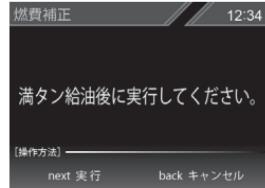
5. OBD II 設定メニューを開き、【セレクトスイッチ】で【燃費補正】を選択、【ネクストスイッチ】で決定します。
