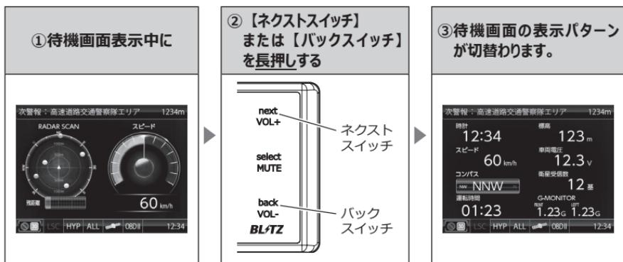
※ 表示項目を切替える場合は、【セレクトスイッチ】を短押しし、表示項目変更モードより変更を行なってください。(⇒ P30)
