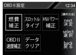
3. 確認画面で【ネクストスイッチ】を短押しし、燃費補正を実行します。
